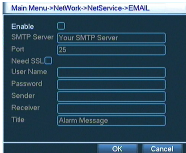
Рис. 4.8. Настройка электронной почты
