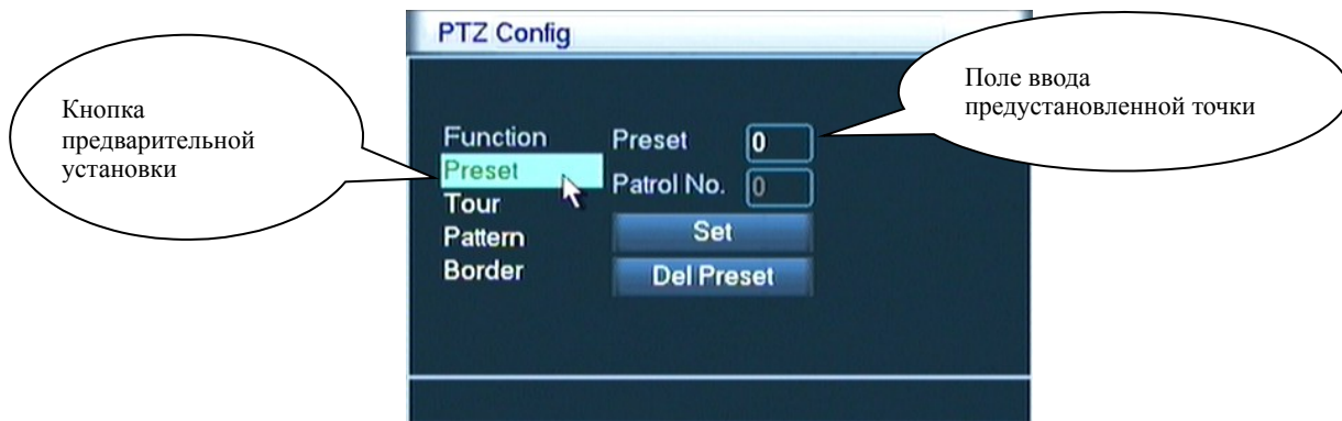
Рис. 3.9. Настройка точек предварительной установки
